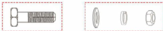
2 M10 Schrauben und die Unterlegscheiben liegen bei.
